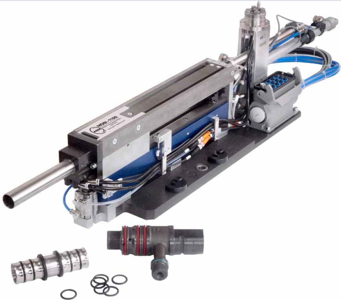
Modul mit integriertem Beölsystem zur Montage von innenliegenden Dichtringen bis zur einer Montagetiefe von 200,00 mm.
